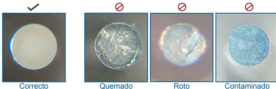
6. Retire la punta del soporte de prueba mediante el extractor de puntas. Si la punta está contaminada en cualquiera de sus extremos, intente limpiarla como se muestra a continuación. Si la punta está dañada, sustitúyala de la de la fresa odontológica con el extractor de puntas y deséchela.
