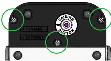
Figura 9.7 Viti del coperchio del vano batterie.
