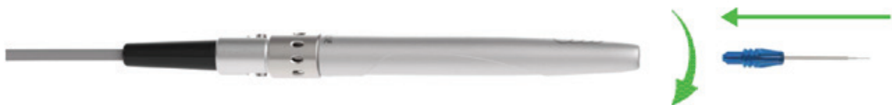
Abbildung 7.4: Stecken Sie die Lichtleiterspitze in das Handstück ( nur wenn das Handstück mit dem Lichtleiter verbunden ist ) und drehen Sie sie im Uhrzeigersinn, bis sie fest sitzt
