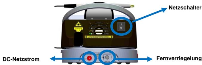
Abbildung 3.1: Netzschalter, DC-Stromeingang, Fernverriegelung
