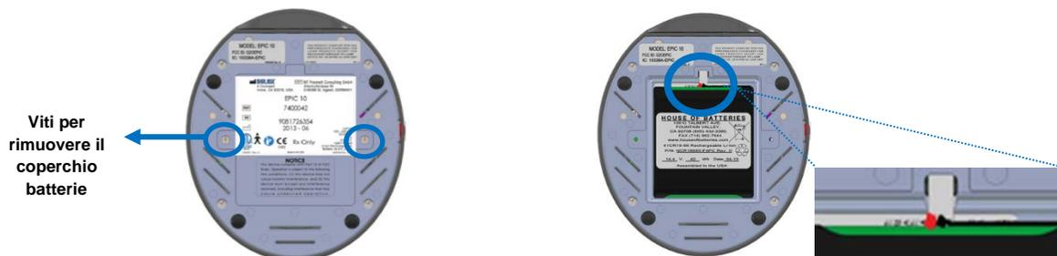
Figura 8.2: Coperchio della batteria/
