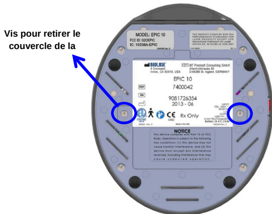
Figure 8.2 : Couvercle de la batterie/dessous de la console
