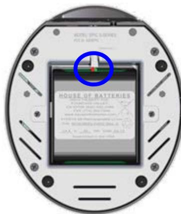
Figura 8.3: Batería/cable conector
