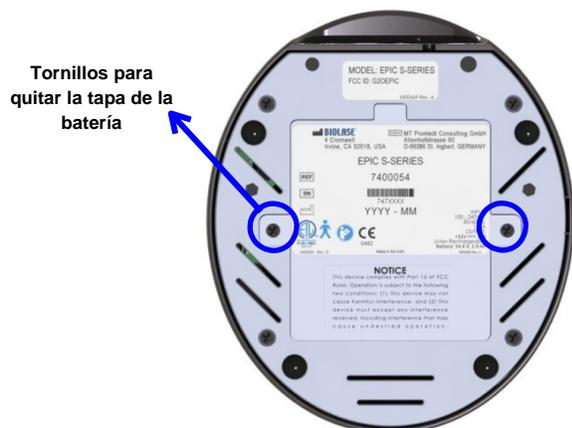
Figura 8.2: Tapa de la batería/parte inferior de la consola
